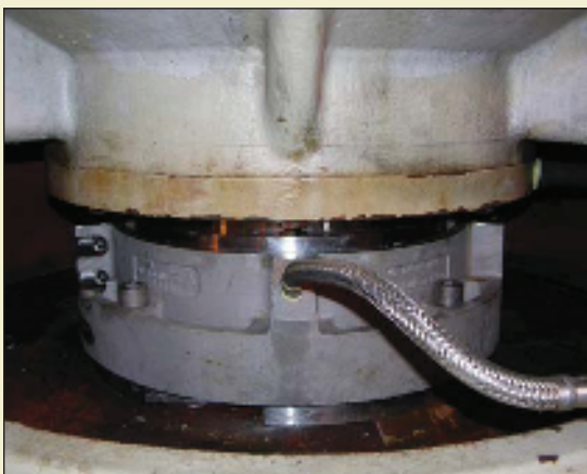
L'installation et la réparation des garnitures mécaniques en deux parties sont effectuées sans démontage de l'équipement, ce qui permet un gain de temps et une réduction des coûts d'exploitation.
